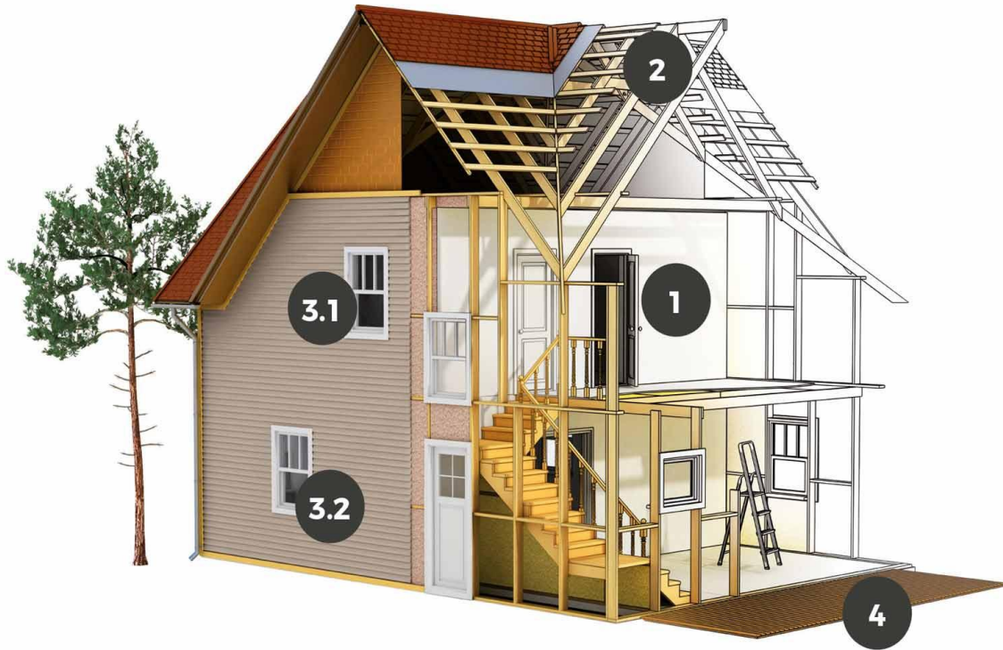
Figure 7 : Illustration des classes d'emploi du bois - Source : www.boisdurablesdebourgogne.fr
